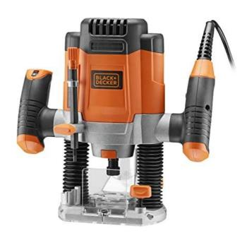
KW1200EPuissance 1200WTaille des collets 6/6,35/8mm
